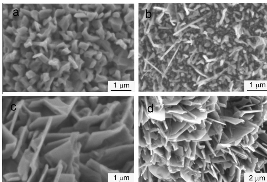
Fig. 4. SEM images of  $\text{TiO}_x$ @C nanostructures grown at 850 °C using (a) 30 min, (b) 60 min, (c) 90 min and (d) 120 min, separately.
